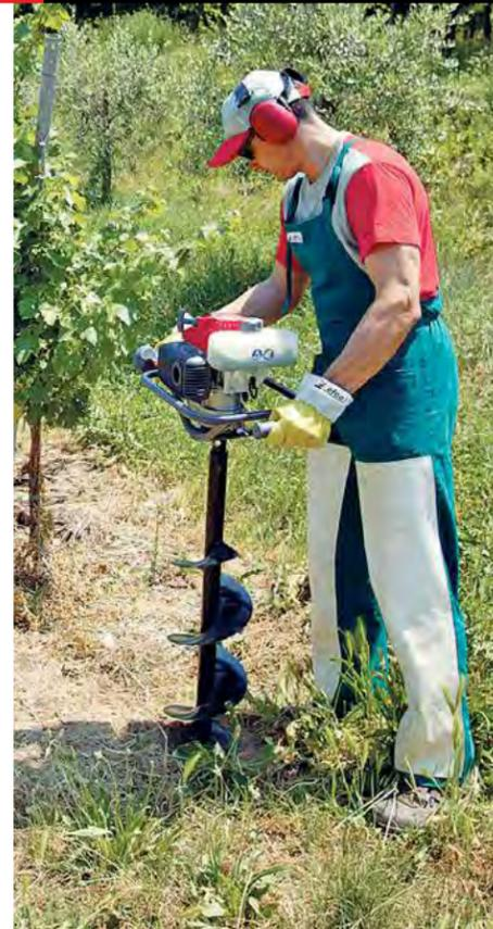
**Motoperforadoras para uno ó dos operadores, según la dificultad del trabajo y las condiciones del suelo.** La gran variedad de barrenas de uno o dos filos amplía las posibilidades de aplicación.
