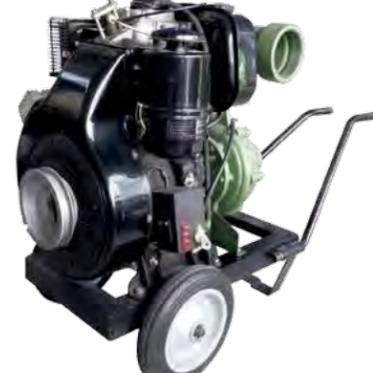
**MOTOBOMBA A DIESEL 17 HP CON ARRANQUE ELÉCTRICO**
